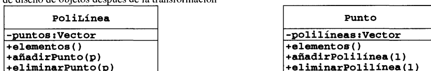
Figura 7-24 Realización de una asociación bidireccional de muchos a muchos (diagrama de clase UML; la flecha indica la transformación del modelo de diseño de objetos).
