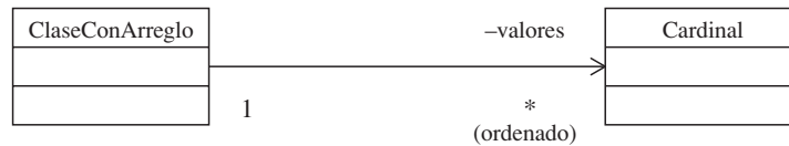
Figura 6-12 Podemos agregar modificadores y detalles a las asociaciones precisamente como las agregaríamos a los campos.
